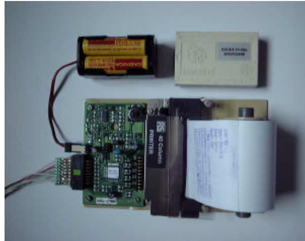
Bild 4 Versuchsaufbau des Autors, vorn Drucker und Interface, hinten externe Spannungsversorgung, BASIC-Tiger®
