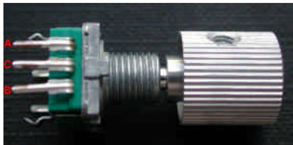
Bild 1 ein mechanischer Rotary-Encoder Bild 2 der Encoder liefert an seinen Ausgängen versetzte Impulse von ALPS
