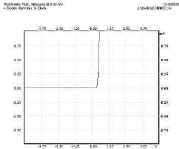
Bild 1 eine typische Diodenkennlinie
